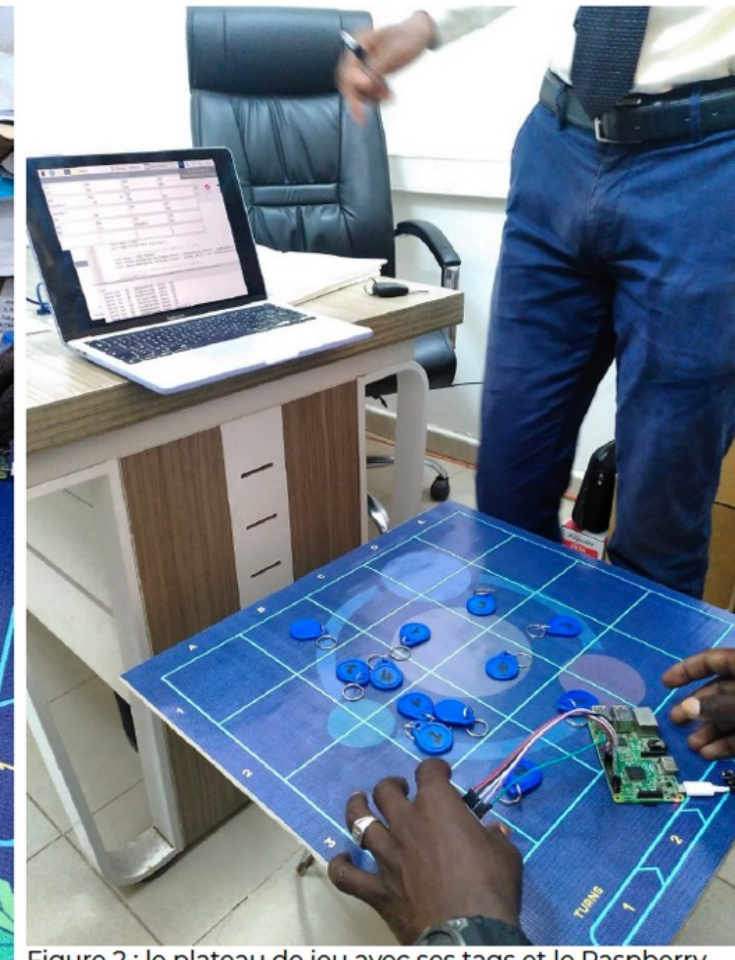
Figure 2 : le plateau de jeu avec ses tags et le Raspberry connecté au scanner (qui lui est caché sous la main)
